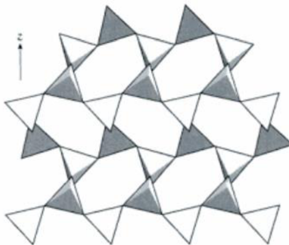
Obrázek 6: Vrstvení sítí tetraedrů u \alpha -cristobalitu [3]
