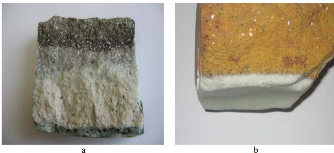
Obrázek 13: Foto použitých diinsových cihel: a) vzorek z klenby sklářské pece, b) vzorek z klenby elektrické vakuové pece [16]
