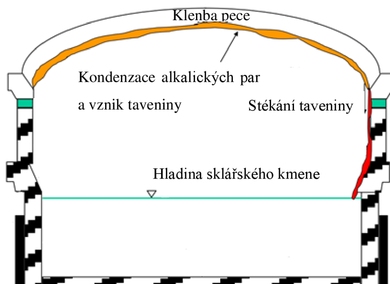
Obrázek 12: Mechanismus koroze dinasové klenby [11]
