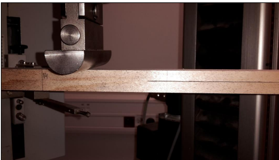
Obr. 28 Detail špice (vrcholu) trhliny při 3ENF zkoušce
