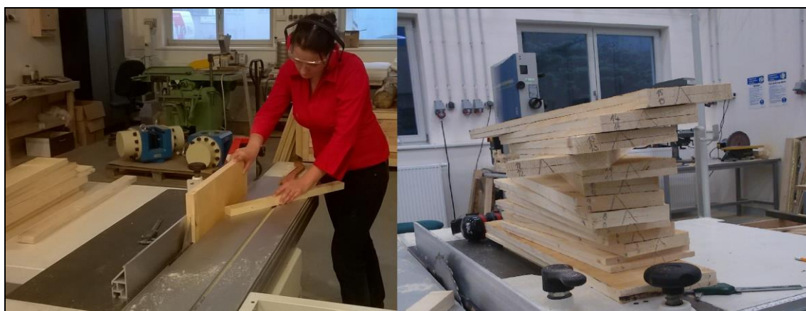
Obr. 20 Rozřezání desek na tloušťku t = 10 \text{ mm} \pm 2 \text{ mm}
