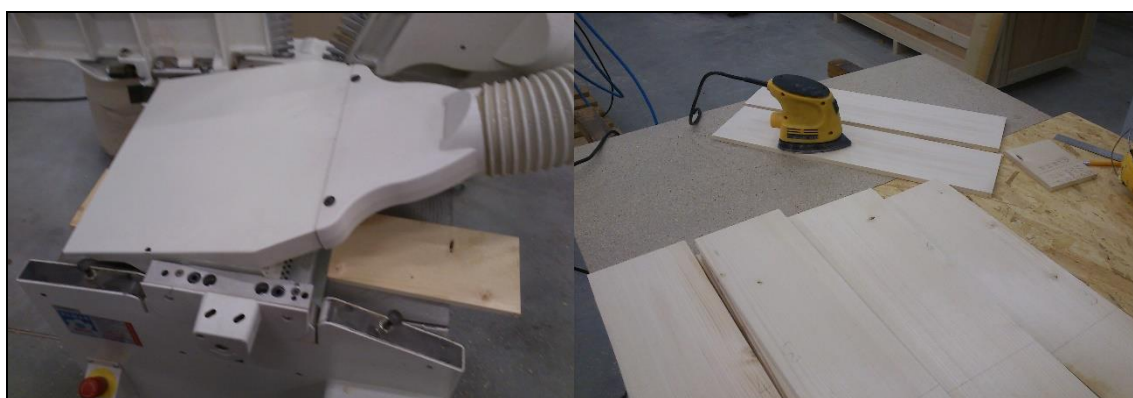
Obr. 21 Protahovací frézka; ruční vibrační bruska – dosažení přesné tloušťky t = 10 \text{ mm}
