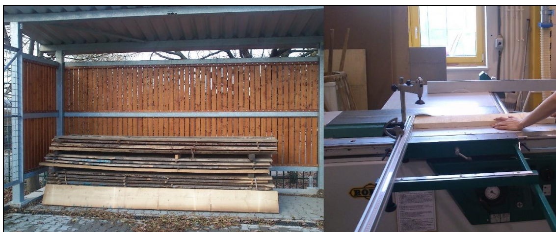
Obr. 19 Dřevo vyskládané v hrání (přirozené sušení), úprava přířezů na formátovací pile
