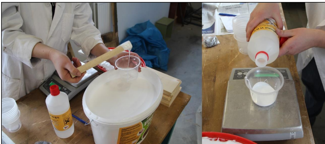
Obr. 22 Navážení PVAc lepidla a přidání tvrdidla
