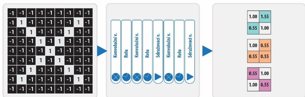
Obr. 4-12 Posloupnost a složení jednotlivých vrstev
