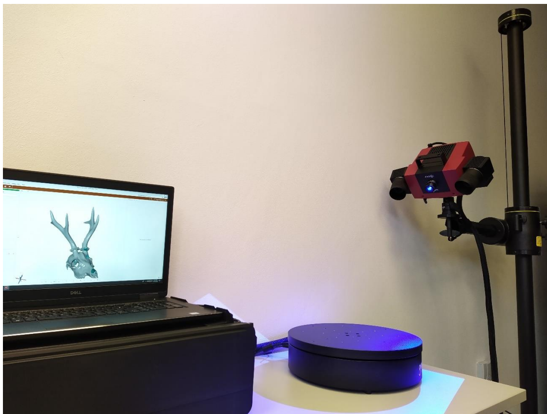
Obrázek 3 - 3D skener s automatickou otočnou podložkou (autorské foto)
