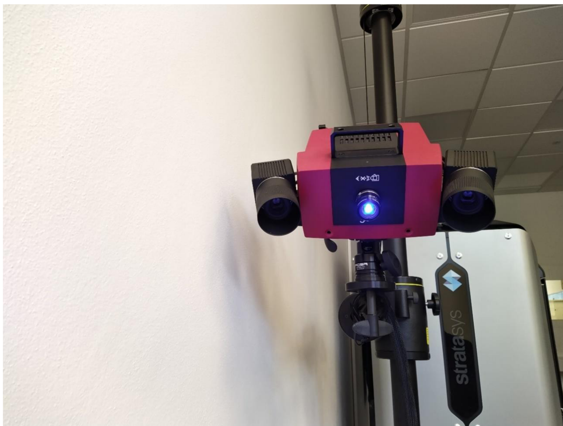
Obrázek 2 - 3D skener ATOS Compact Scan 12M Essential Line s kamerami (autorské foto)
