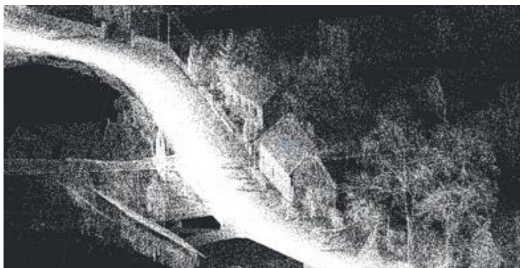
Příklad laserového zaměření obce Vlčnov - mračno bodů o 47 mil. bodech (URL 15)
