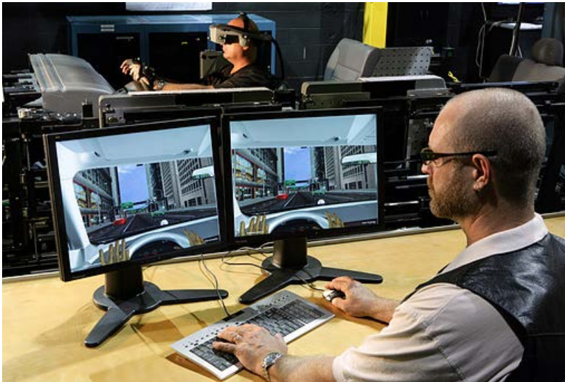
Obr. 18 Posuzování výhledových úhlů pomocí virtuálních brýlí
