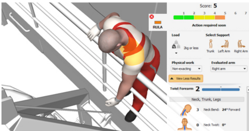
Obr. 2 Hodnocení zátěže v důsledku polohy těla (RULA)
