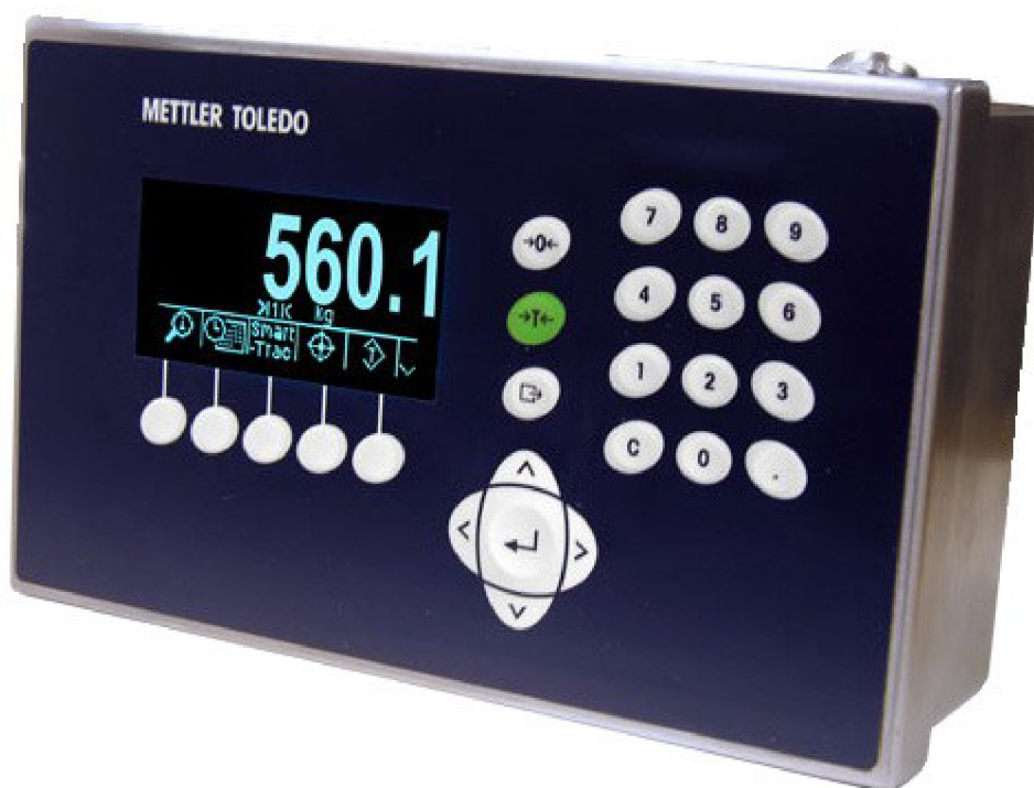
Obr. 3.1: Váhový terminál IND560
