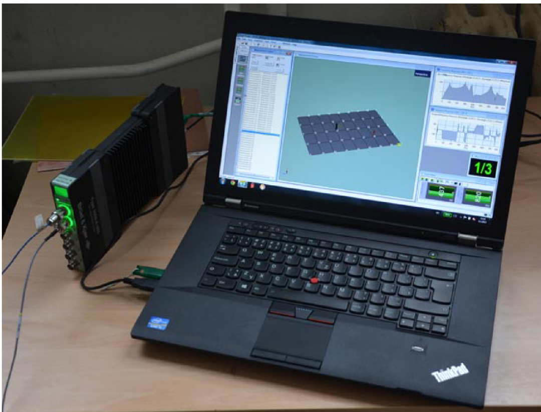
Obr. 9.3 Multianalyzátor PULSE LAN-XI propojený s laptopem. Ve spuštěném softwaru si lze všimnout geometrie desky se zvolenou sítí měřených bodů.
