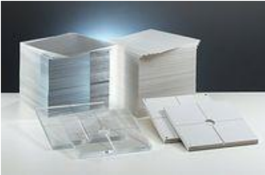
Obr. č. 9: deskový fantom, vlevo akrylový materiál, vpravo PMMA (23)
