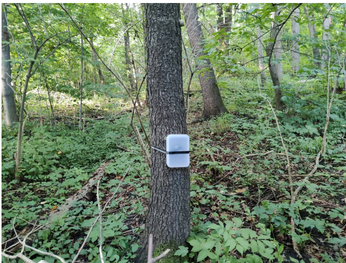
Obrázek 7.1: Měření dosahu navigačního bodu v lese
