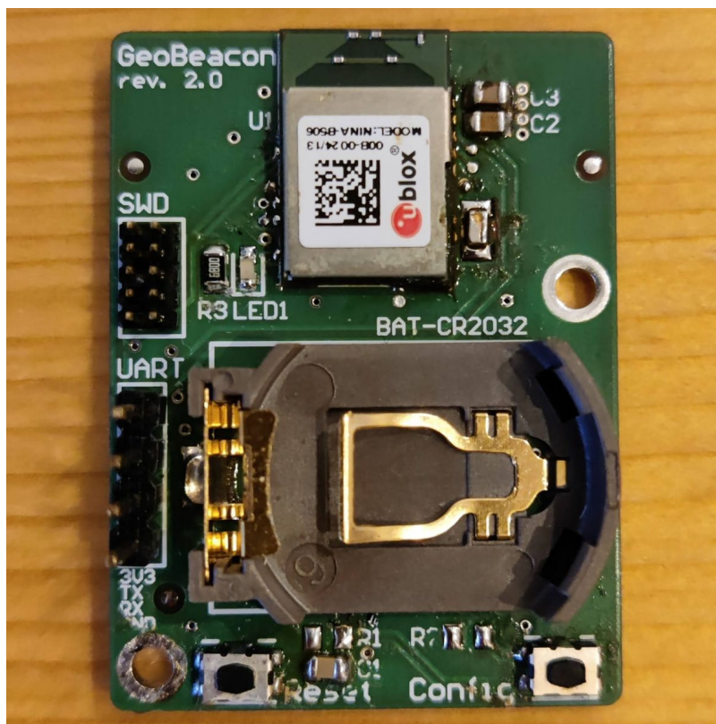
Obrázek 6.2: Fotografie vyrobeného prototypu navigačního bodu s modulem NINA-B506
