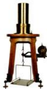
Obrázok 20 Curieho piezoelektrické chemické mikrováhy [48]
