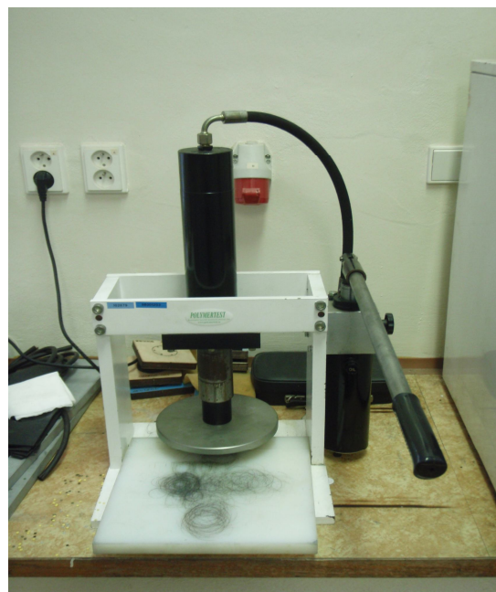
Obrázok 34 Vysekávač vzorky a hydraulický lis
