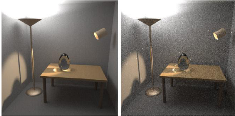
Obrázok 2.7: vľavo bi-directional path tracing (25 vzoriek na pixel), vpravo klasický path tracing (56 vzoriek na pixel) s rovnakým výpočtovým časom
