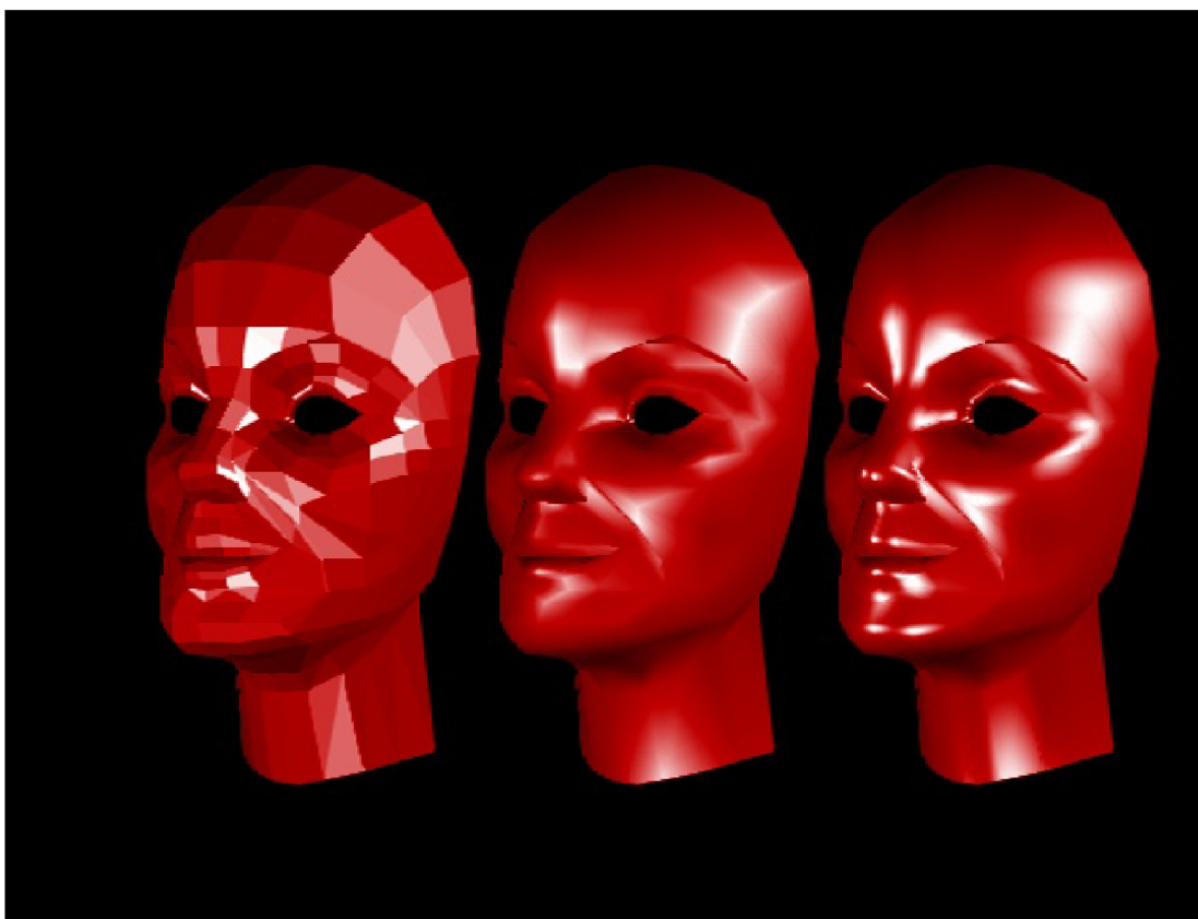
Obrázok 4.6: porovnanie výsledkov troch typov tieňovania, zľava ploché tieňovanie ( flat shading ), Gouraudovo a Phongovo tieňovanie.
