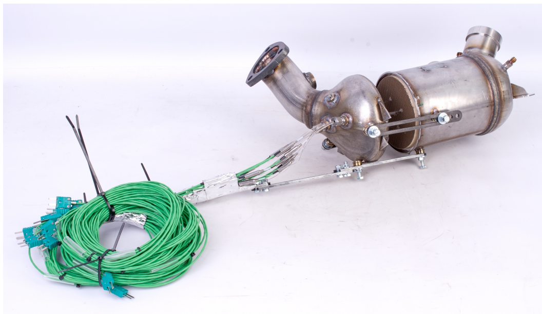
Obrázek 5.4: Přední část katalyzátoru s instalovanými termočlánky
