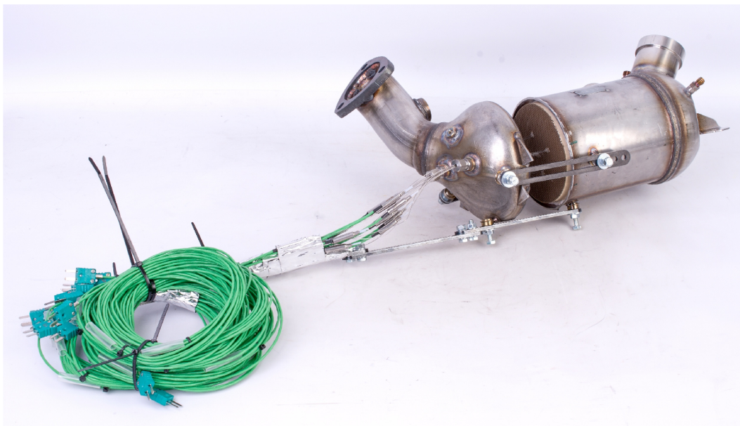
Obrázek 5.4: Přední část katalyzátoru s instalovanými termočlánky
