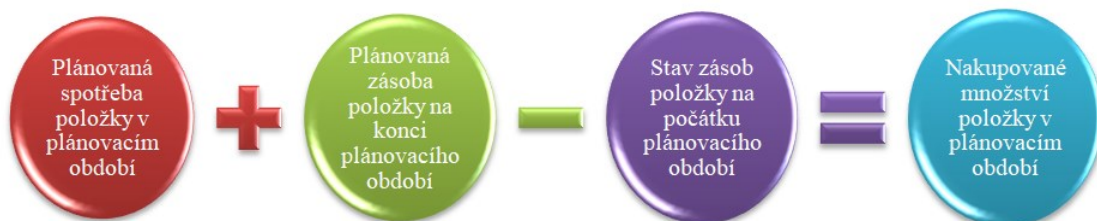
Obr. 1.3 Vzorec pro nakupované množství položky v plánovacím období
