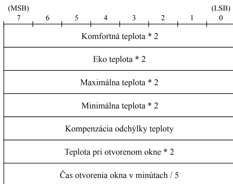
Obr. 3.11: Správa typu 0x11 – konfigurácia predvolených hodnôt teploty
