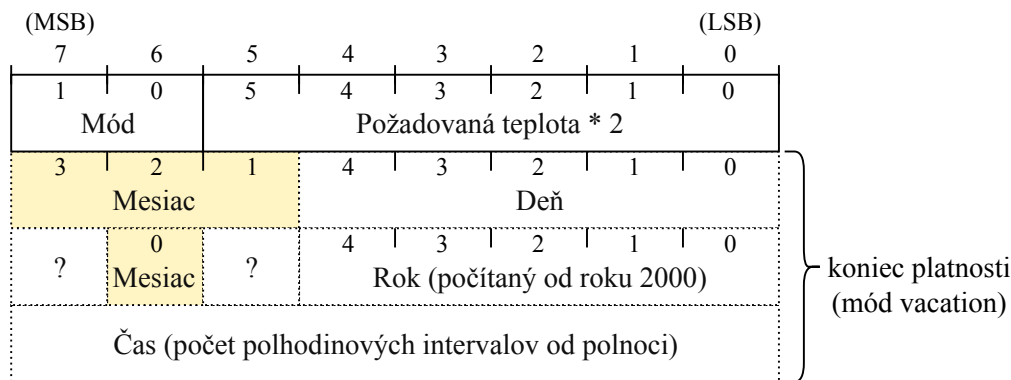
Obr. 3.13: Správa typu 0x40 – nastavenie teploty
