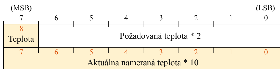
Obr. 3.14: Správa typu 0x42 – aktuálny stav nástenného termostatu
