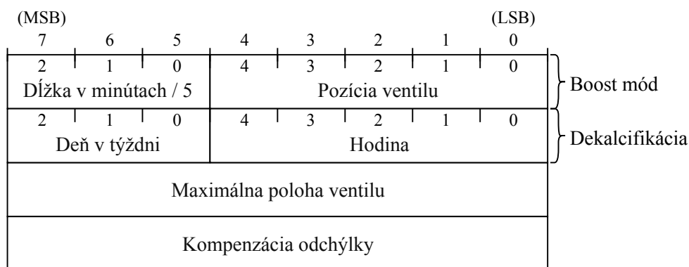
Obr. 3.12: Správa typu 0x12 – konfigurácia ventilu
