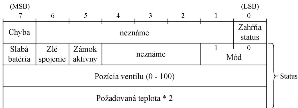
Obr. 3.8: Správa typu 0x02 – potvrdenie o doručení
