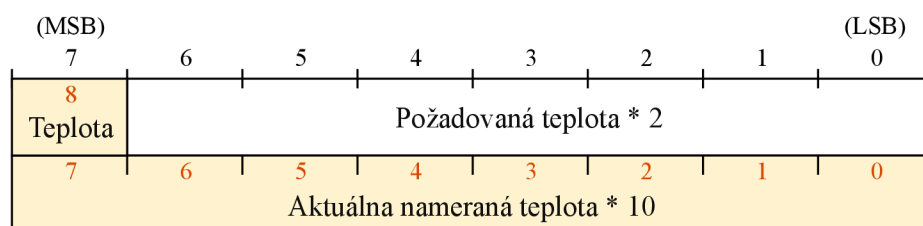
Obr. 3.14: Správa typu 0x42 – aktuálny stav nástenného termostatu
