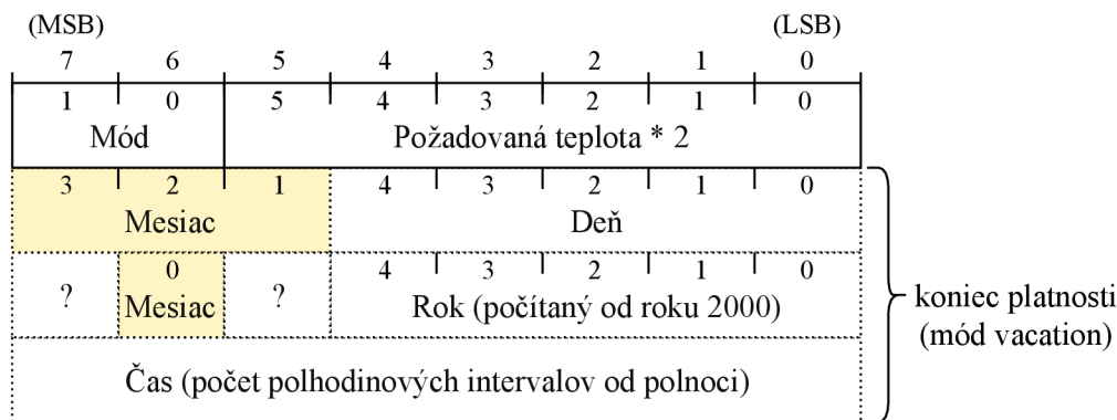
Obr. 3.13: Správa typu 0x40 – nastavenie teploty
