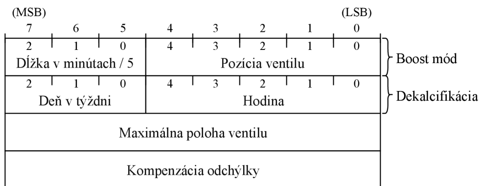
Obr. 3.12: Správa typu 0x12 – konfigurácia ventilu
