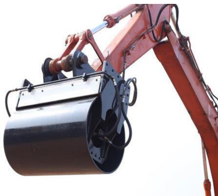
Obr. 35 Vibrační válec hladký určený pro rypadla značek Kunti Machine [72]
