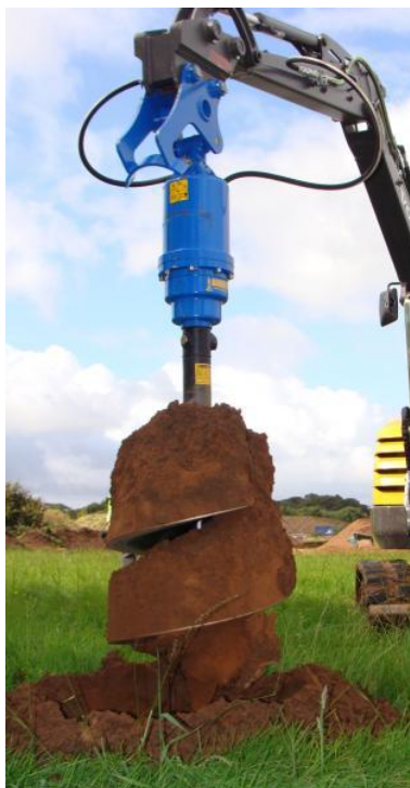
Obr. 5 Vrtací zařízení Auger Torque při pracovním procesu [9]
