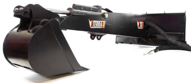
Obr. 18 podkopové zařízení s možností pohybu pouze v jedné rovině [44]
