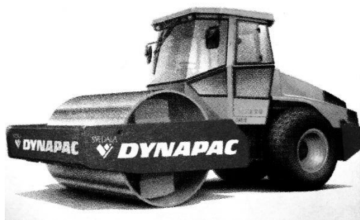
Obr. 32 Vibrační válec hladký tahačový [67]
