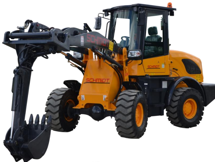
Obr. 15 Přídavné podkopové zařízení pro čelní nakladač značky Schmidt [40]
