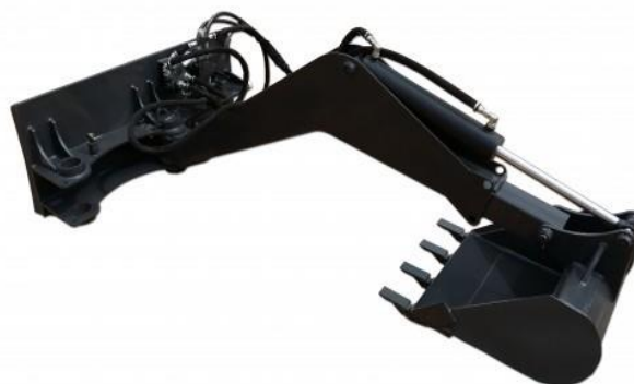
Obr. 17 podkopové zařízení s pohybem lžice do boků [43]
