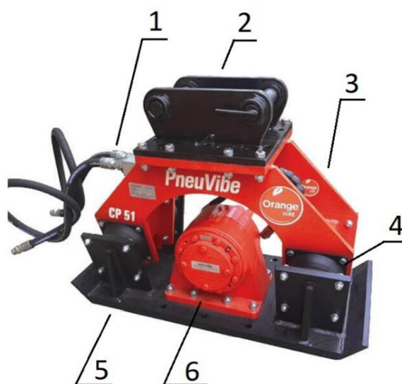
Obr.22 Základní konstrukční prvky závěsné hutnicí desky [52][52]
