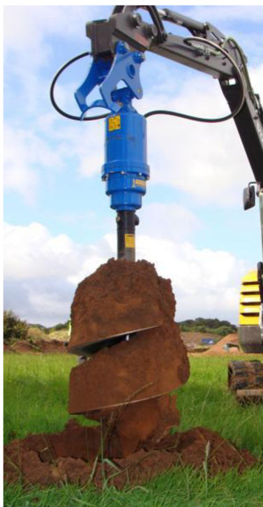
Obr. 5 Vrtací zařízení Auger Torque při pracovním procesu [9]
