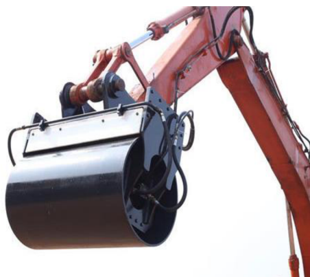
Obr. 35 Vibrační válec hladký určený pro rypadla značky Kunti Machine [72]
