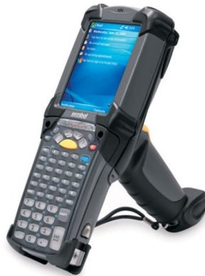
Obr. 1 2 Mobilní terminál pro čtení čárových kódů (mobilní skladník)
