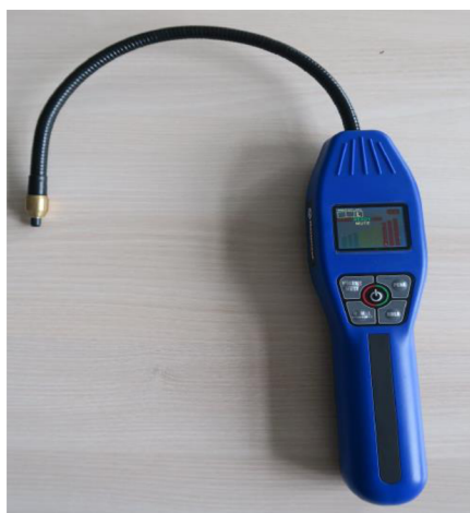
Obrázek 2.20 Elektronický detektor úniku chladiv [3]
