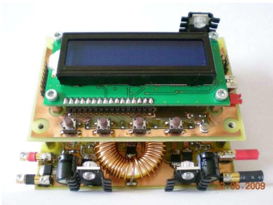
Obr. 6.11: Celková sestava výkonové nabíjecí části testeru
