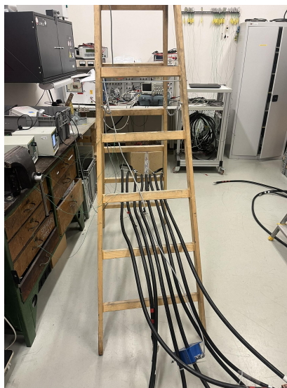
Obr. 5.1: Zapojení nedotékajících se kabelů
