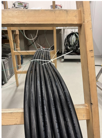
Obr. 5.2: Zapojení dotékajících se kabelů
