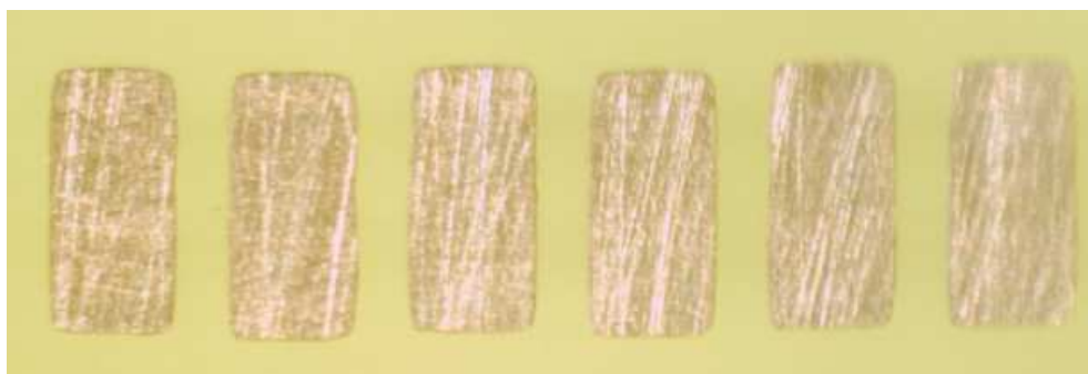
Obrázek 43: Pájecí plošky na DPS
