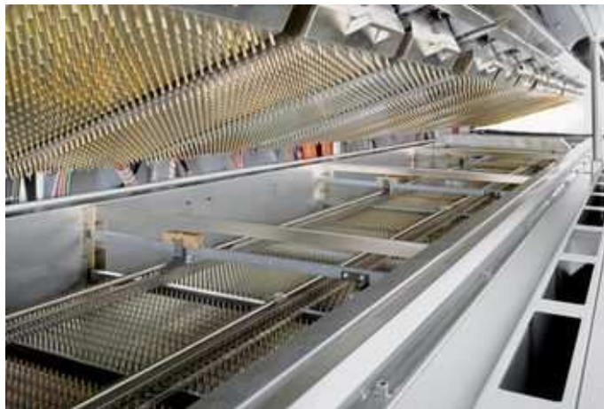
Obrázek 3: Pec pro pájení přetavením s konvekčním ohřevem, převzato z [11].
