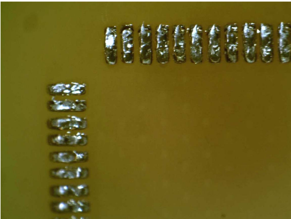
Obrázek 79: Demontovaný integrovaný obvod
