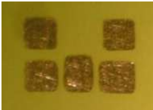
Obrázek 67: Pájecí plošky pro DSBGA5
