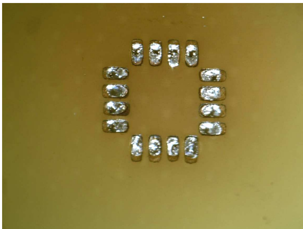
Obrázek 97: Demontovaný integrovaný obvod
