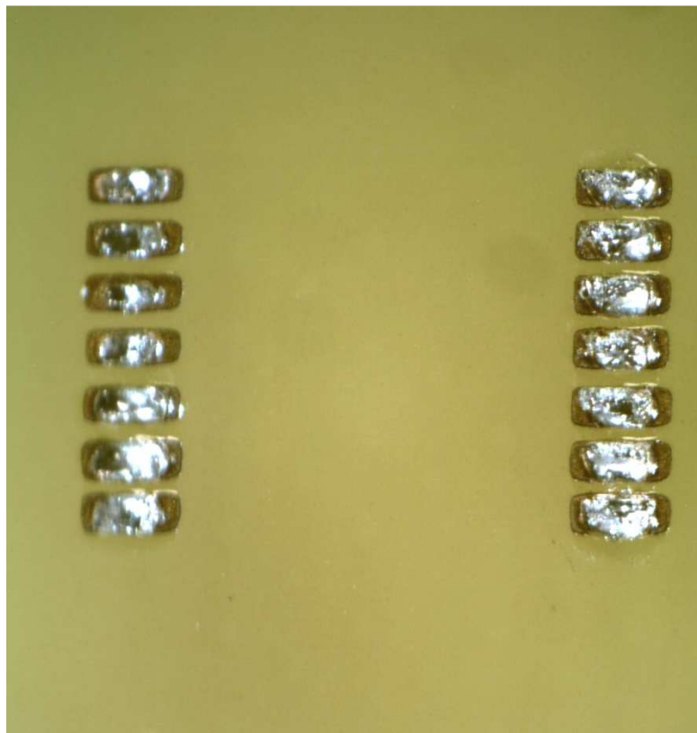
Obrázek 91: Demontovaný integrovaný obvod
