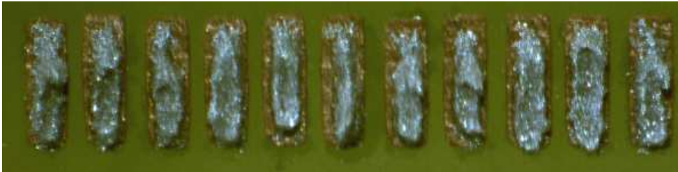
Obrázek 37: Natisknutá pájecí pasta
