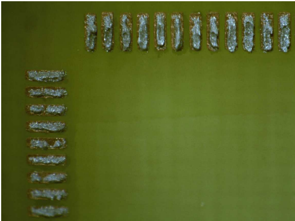
Obrázek 76: Natisknutá pájecí pasta
