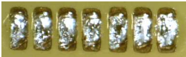
Obrázek 56: Demontovaný integrovaný obvod
