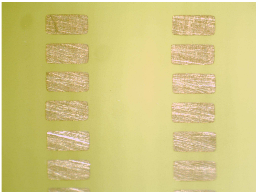
Obrázek 80: Pájecí plošky na DPS
