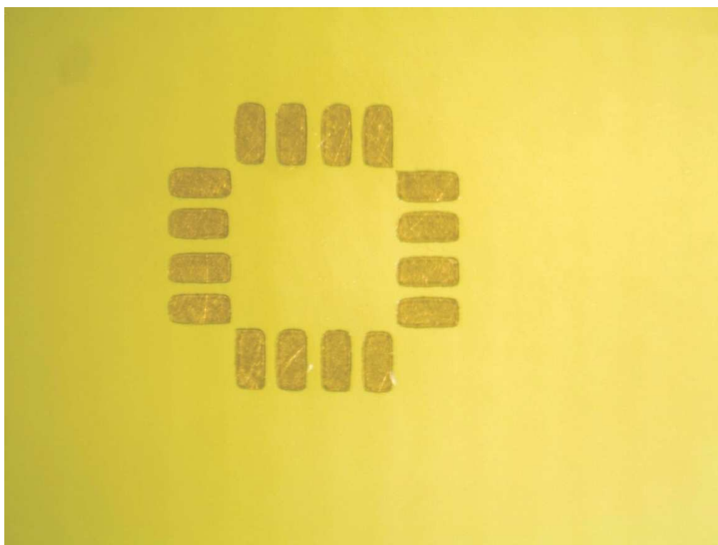
Obrázek 92: Pájecí plošky na DPS
