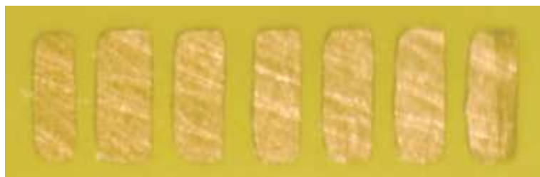
Obrázek 51: Pájecí plošky na DPS
