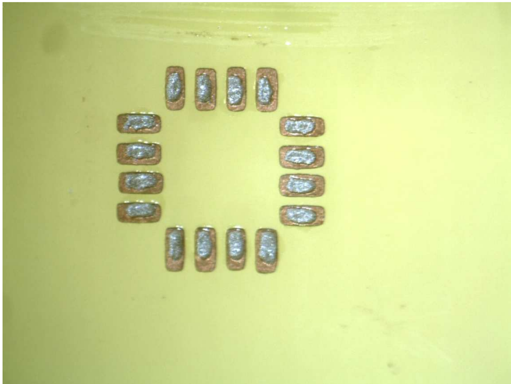
Obrázek 94: Natisknutá pájecí pasta
