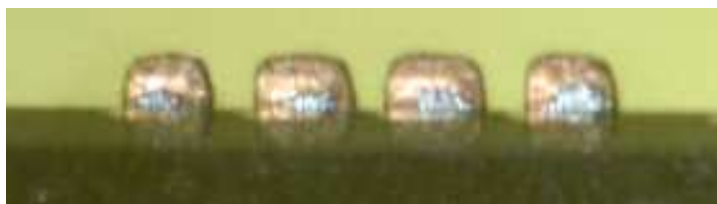
Obrázek 62: Osazený integrovaný obvod do pájecí pasty
