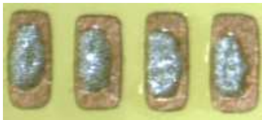
Obrázek 61: Natisknutá pájecí pasta
