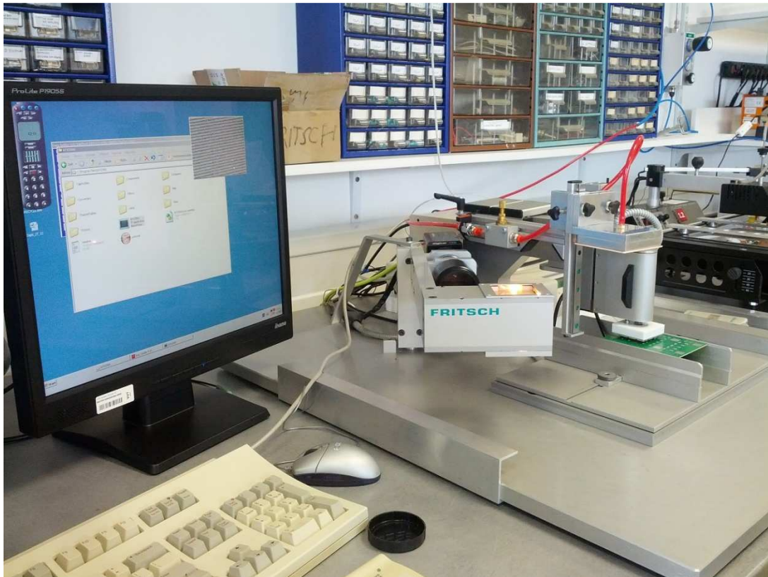
Obrázek 21: Opravářská stanice Fritsch Mikroplacer.
