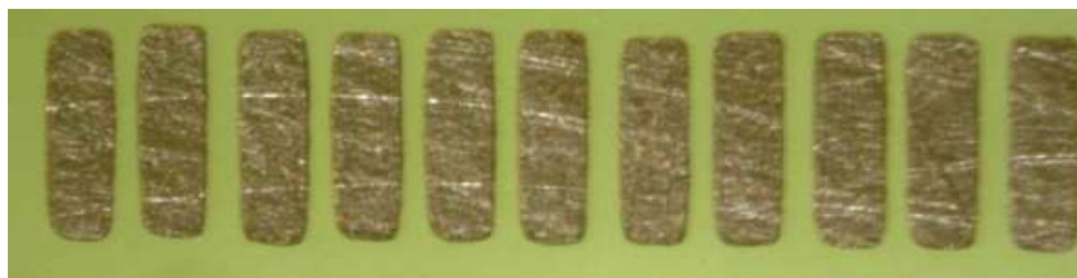
Obrázek 35: Pájecí plošky na DPS
