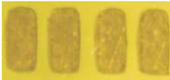
Obrázek 59: Pájecí plošky na DPS
