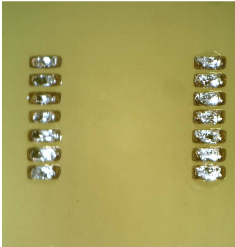
Obrázek 91: Demontovaný integrovaný obvod
