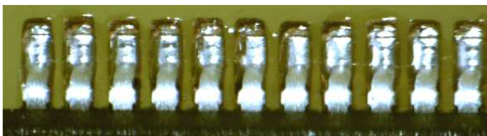
Obrázek 39: Zapájený integrovaný obvod
