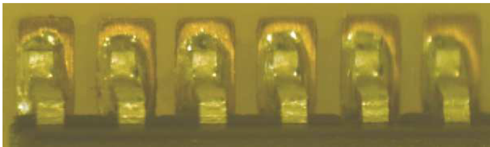
Obrázek 47: Zapájený integrovaný obvod
