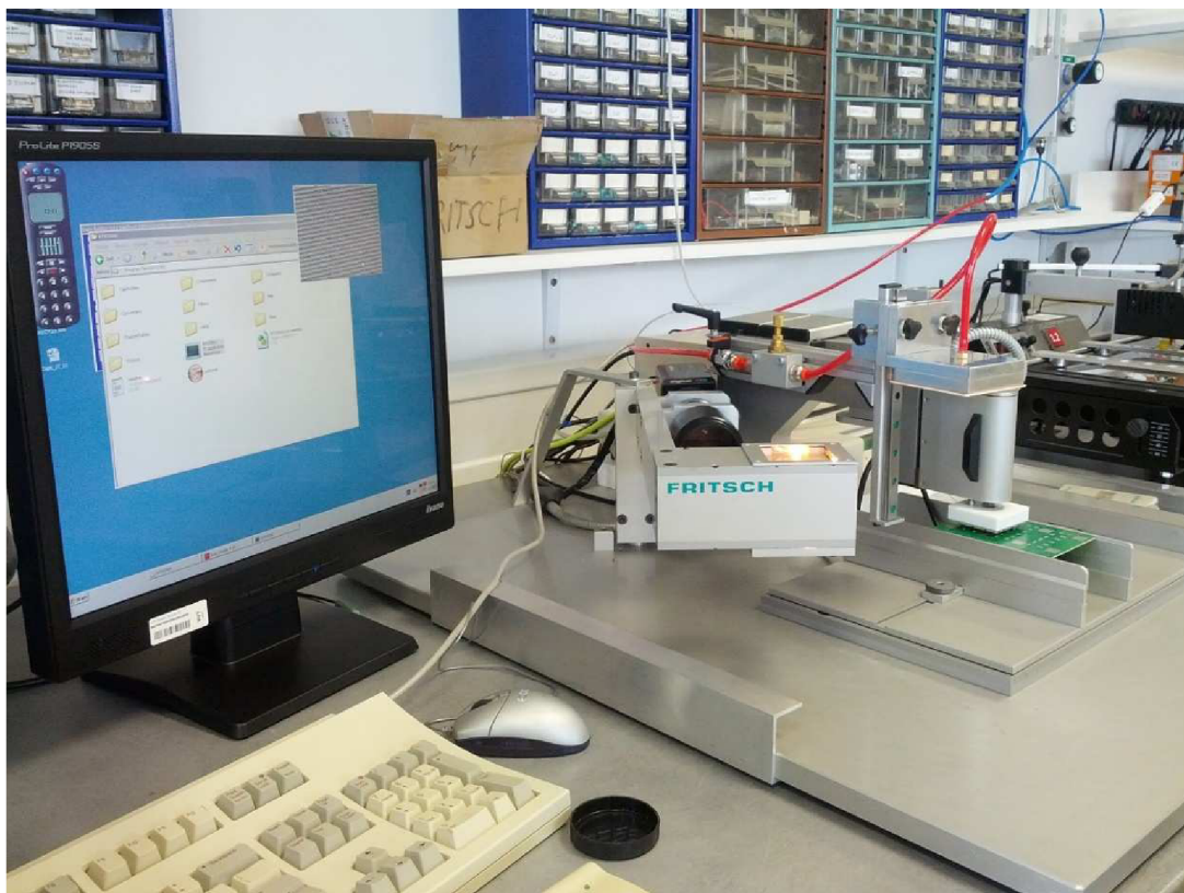
Obrázek 21: Opravářská stanice Fritsch Mikroplacer.
