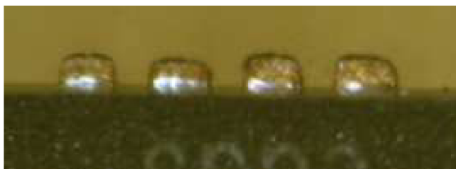
Obrázek 63: Zapájený integrovaný obvod
