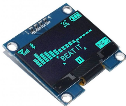
Obr. 2.4: Vybraný OLED displej [14]
