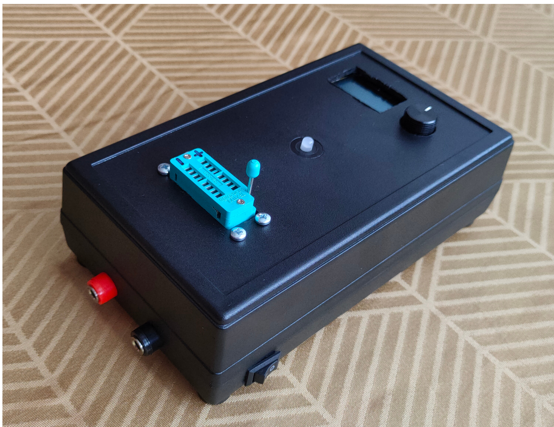
Obr. 3.15: Finální podoba testeru
