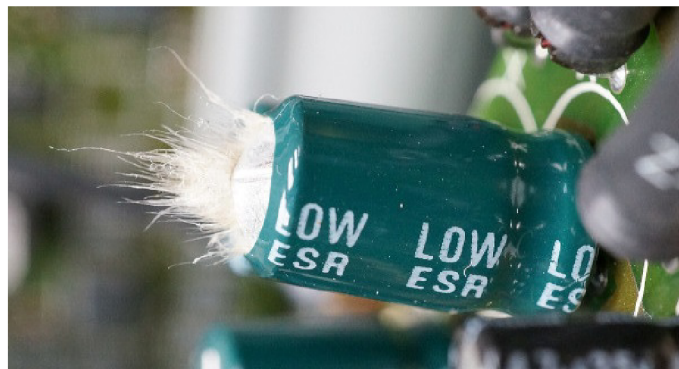
Obr. 1.11: Vadný elektrolytický kondenzátor, který explodoval přes přetlakovou pojistku [7]
