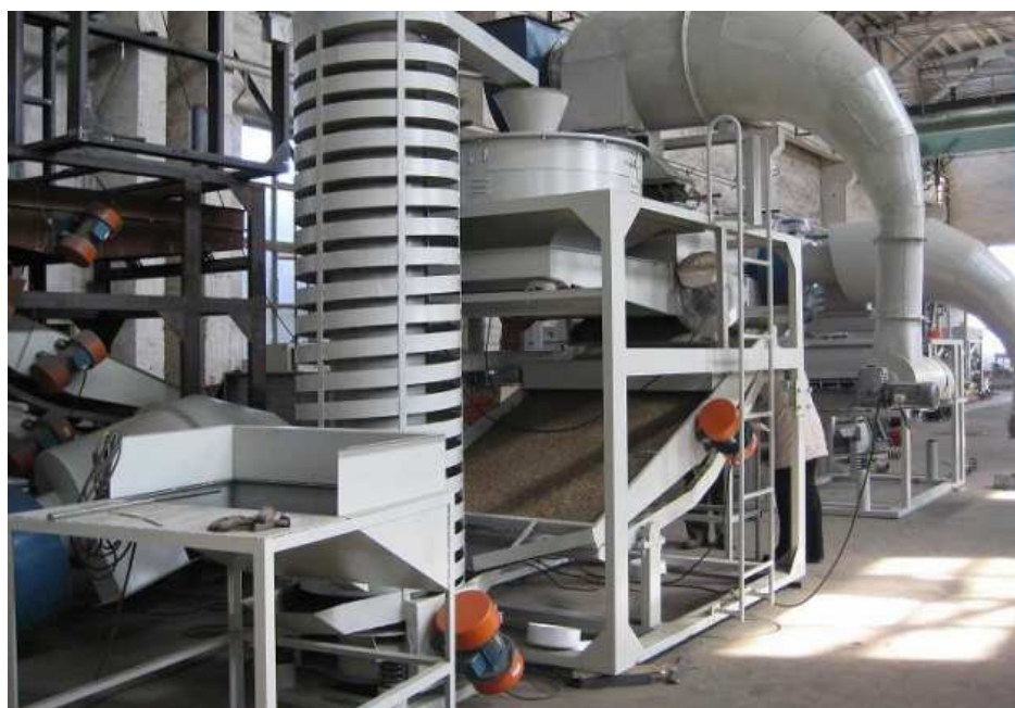
Obrázek 10: Loupačka pro kompletní zpracování semen konopí TFHM300 používaná v Číně (Anonym 2011-1)
