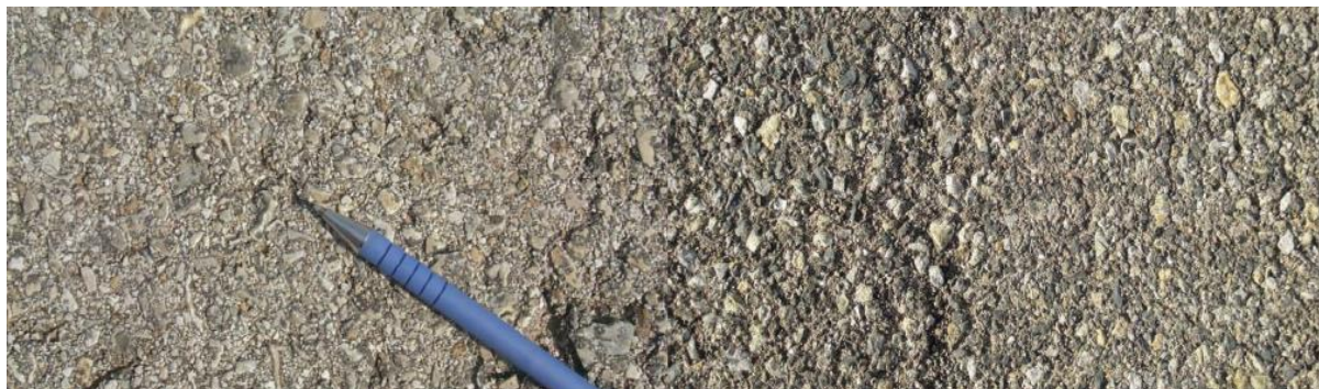
Obr. 13 Rozvinutie na asfaltových vozovkách [10]
