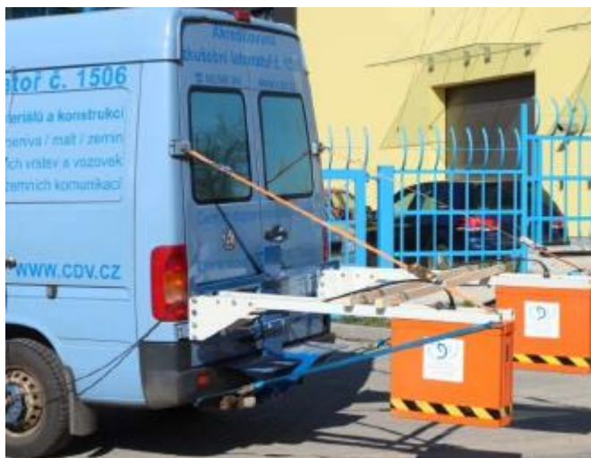
Obr. 32 Vozidlo s georadarom [43]
