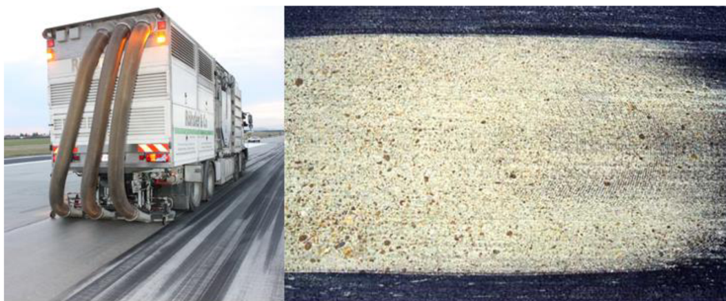
Obr. 22 Zariadenie a výsledok po odstránení gúmy [30]
