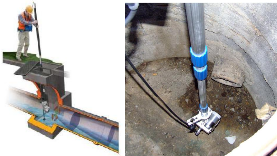
Obr. 9.5 Příklad vizuální kontroly pomocí šachtové kamery [21][24]
