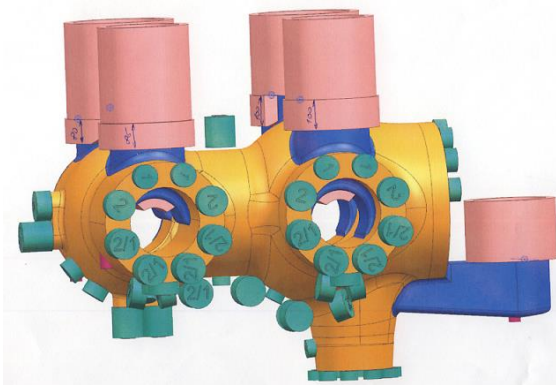
Obr. 29 Simulace lití bloku regulačního ventilu v Magma.
