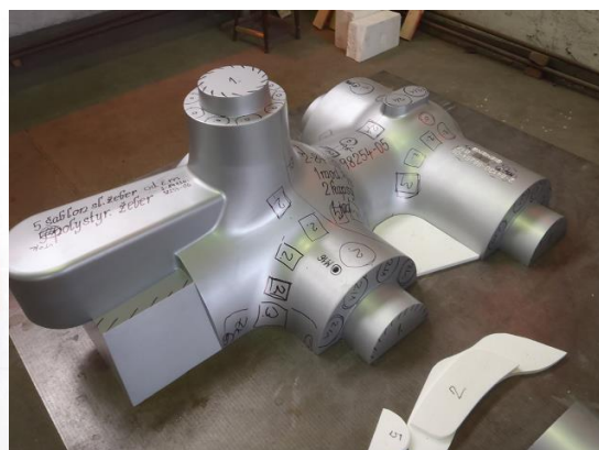
Obr. 30 Model bloku regulačního ventilu s technologií lití.
