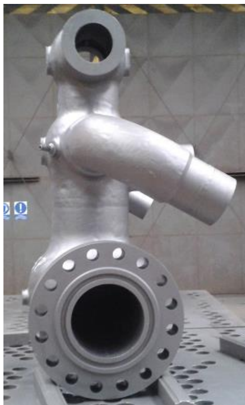
Obr. 36 Ventilová skříň v tryskaném stavu.
