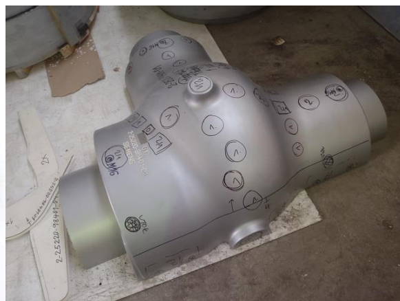
Obr. 32 Model R-ventilu s technologií lití.
