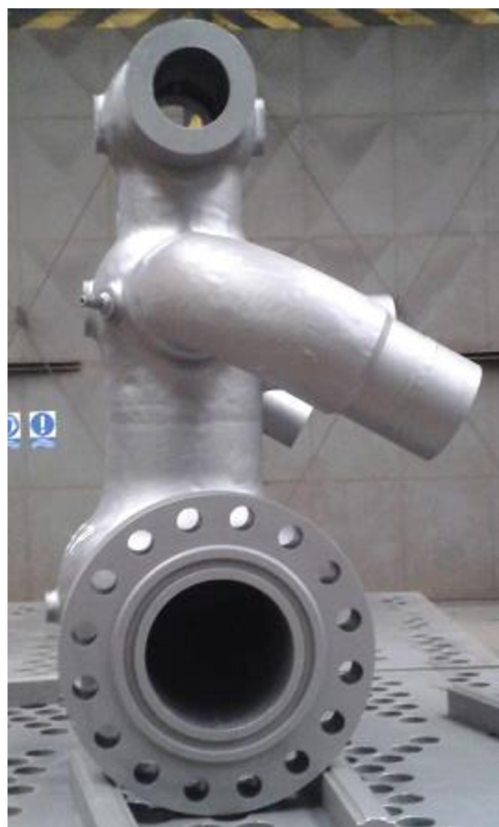
Obr. 36 Ventilová skříň v tryskaném stavu.
