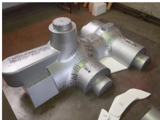
Obr. 30 Model bloku regulačního ventilu s technologií lití.
