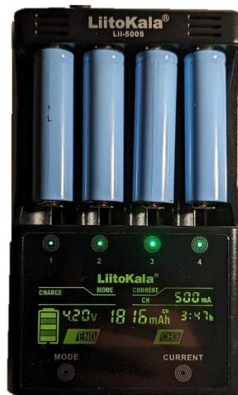
Obrázek 4.2 Testování jednotlivých článků chytrou nabíječkou
