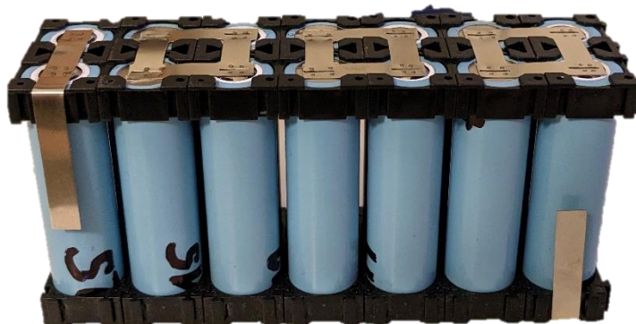
Obrázek 4.3 Vyroběný a nabíjený battery-pack 7S2P
