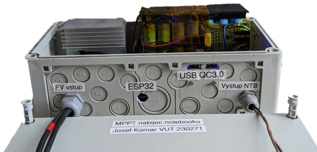
Obrázek 4.14 Kompletní zařízení s popisy na štítcích
