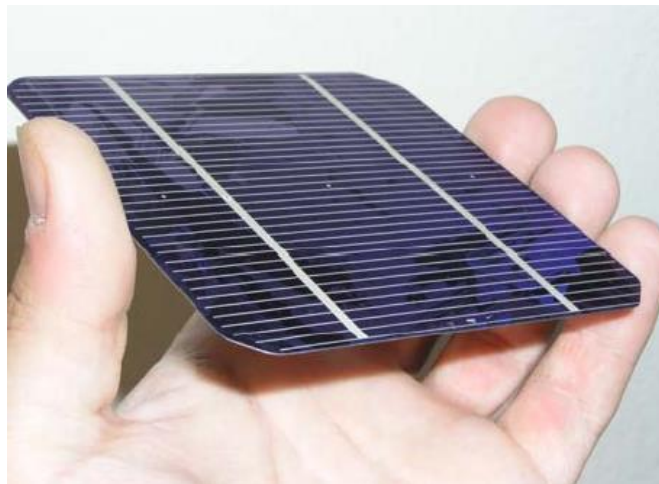
Obrázek 1.1 Fotovoltaický článek, lze pozorovat sběrné vodiče [2]
