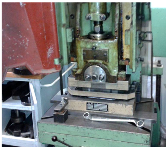
Obr. 27 Upnutí střížného nástroje pro stříhání vzorků pro tahovou zkoušku
