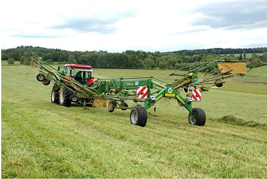
Obr. č. 19 Hydraulické sklápění třírotorového shrnovače Swadro 1010 do transportní polohy
