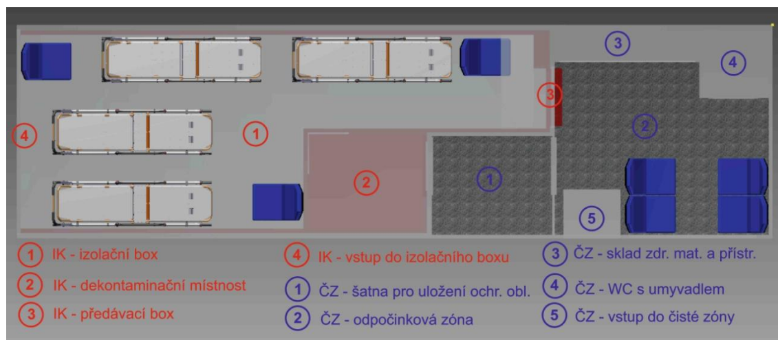
Obrázek 3: Základní rozdělení zadní nástavby vozidla
