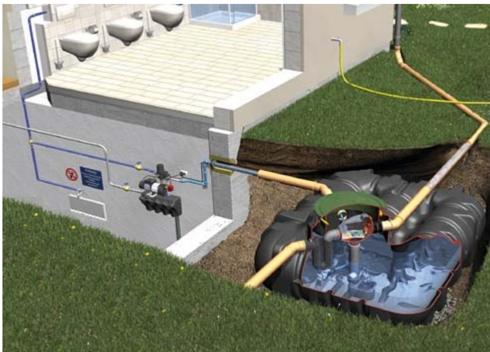
Obrázek č. 16: Příklad vsakovacího zařízení u průmyslového objektu
