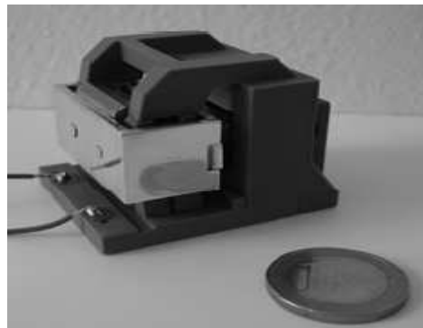
Obr. 4 Skutečný generátor VUT na 17 Hz
