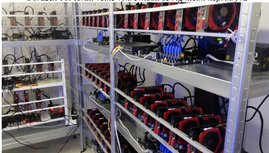
Obrázek 18: Kvůli velké výhřevnosti se rig ničím nepřikrývá
