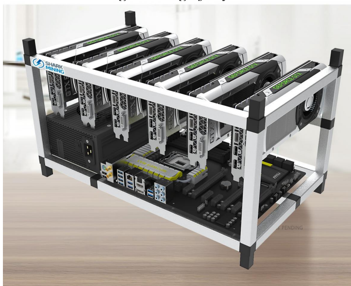
Obrázek 13: Rig se šesti grafickými kartami
