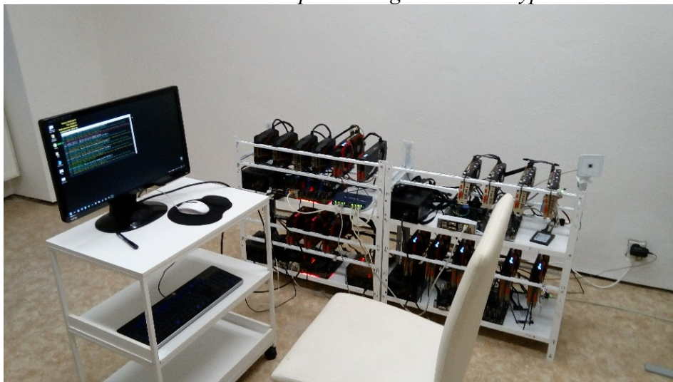
Obrázek 17: Sestavení prvních rigů na těžbu kryptoměn
