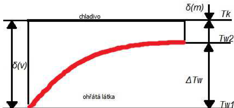
Obr. 8 – Průběh teplot v kondenzátoru (srážníku)
