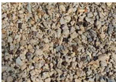
Obr. č. 7: Recyklát betonový 4-32, 8-32, 8-50 (střední)
