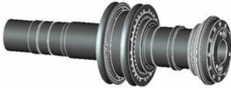
Obr. 34: 3D nezjednodušený model pro řešení torzní tuhosti sestavy vřeteně
