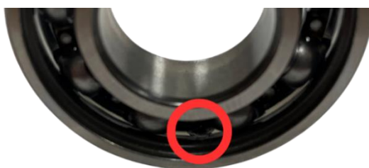
Obr. 42: Porucha na vonkajšom krúžku ložiska L2
