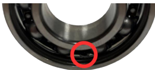
Obr. 42: Porucha na vonkajšom krúžku ložiska L2
