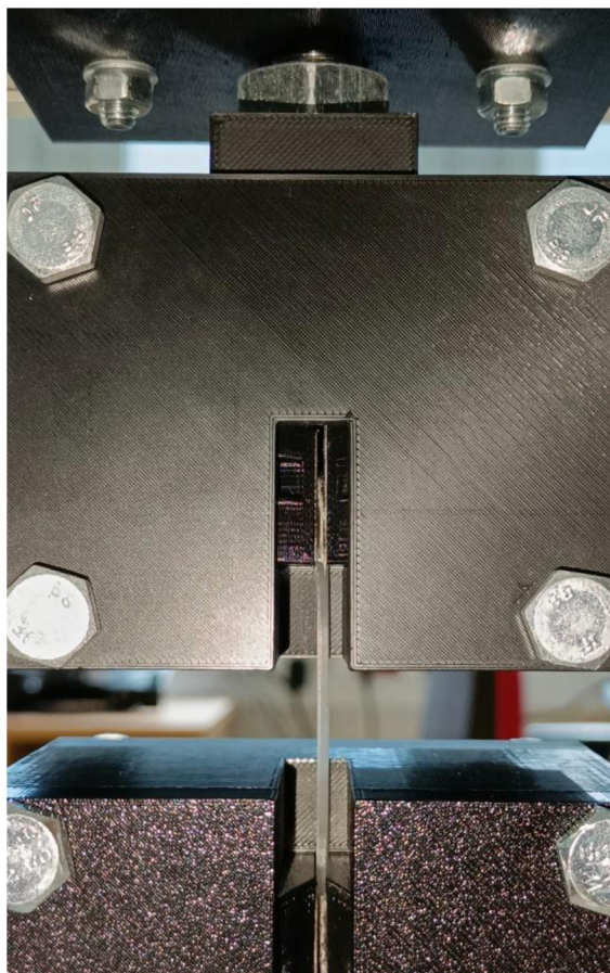
Obrázek 6.5: Příklad vhodného uložení testovacího vzorku v kleštinách a nastavení kamery
