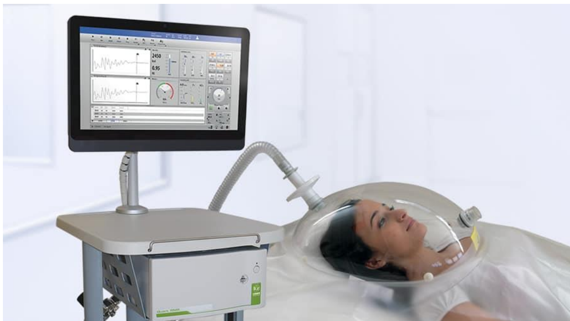
Obr. 12: Moderní analyzátor k měření nepřímé kalorimetrie s využitím kanopy.
