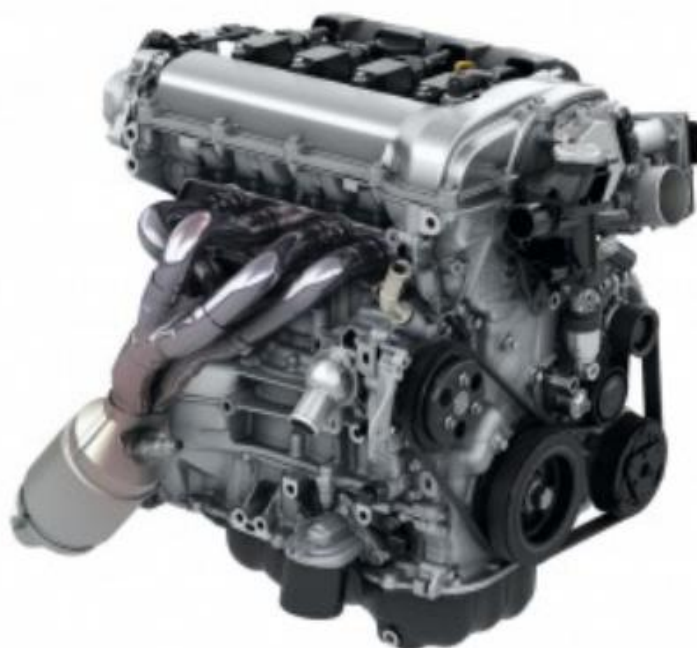
Obr. 19 Pohled na motor Skyactiv G-90 ze strany výfuku [41]
