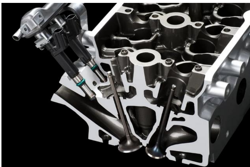
Obr. 14 Detail řezu hlavou válců motoru H4M C6/MU [31]
