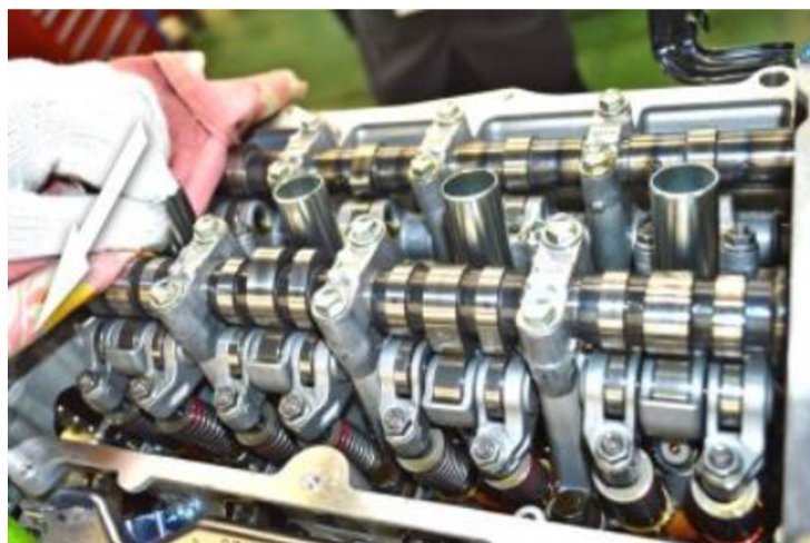
Obr. 17 Detailní pohled na vačkové hřídele uložené v hlavě válců motoru L15B [38]
